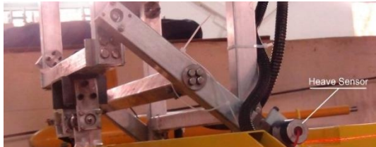
شکل ۲. حس گر اندازه گیری مقدار جابجایی عمودی مدل نصب شده روی پیلون
