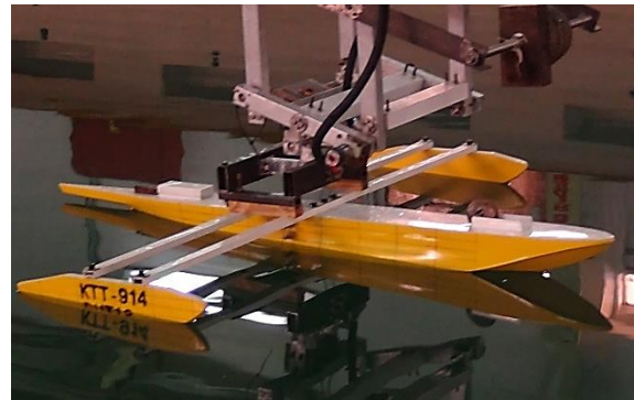
شکل ۴. مدل هیدرودینامیکی، پیلون و مکانیزم اتصال به ارايه
