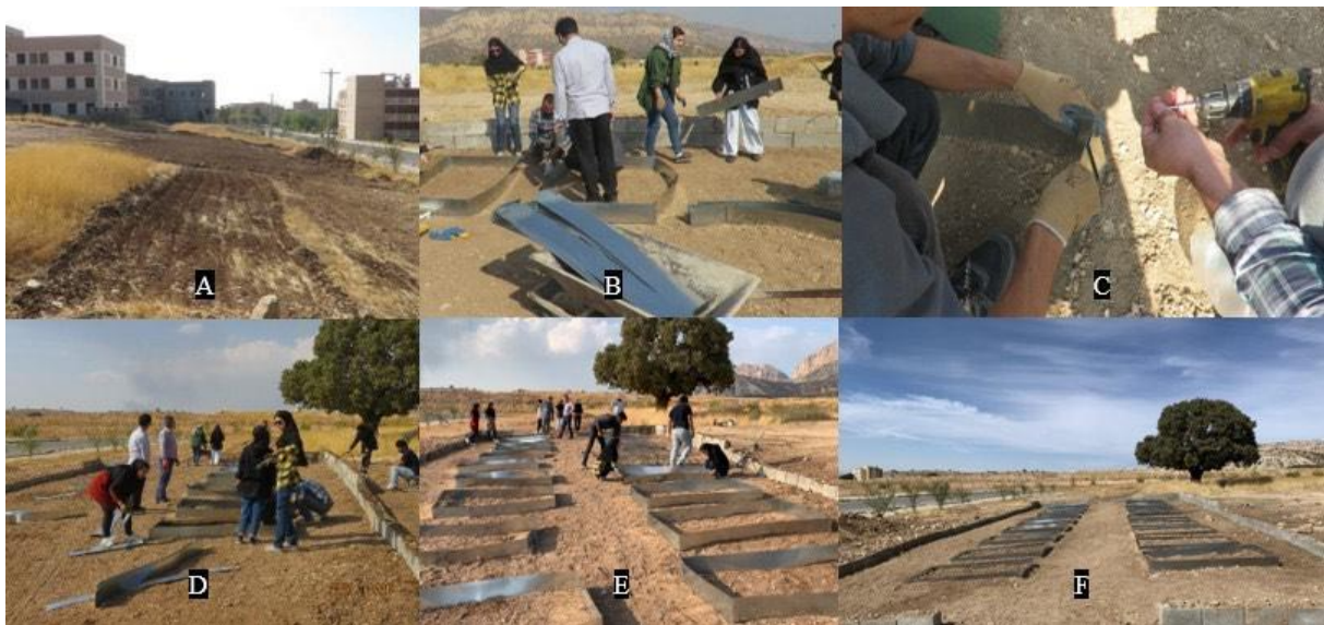
شکل ۲. مراحل طراحی و احداث ایستگاه تحقیقاتی فرسایش و رسوب
