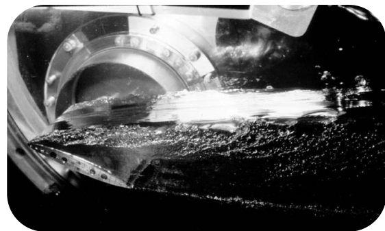
شکل ۱. سوپرکاویتاسیون دوبعدی پشت هیدروفویل ناسا ۱۶۰۱۲ [۱]
