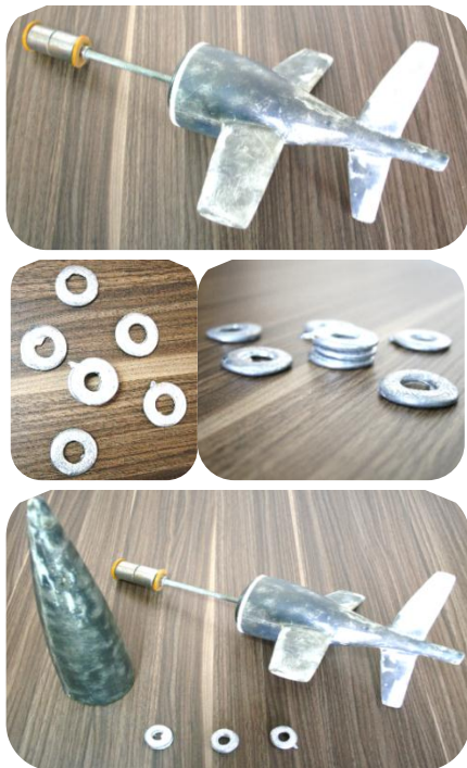
شکل ۱۳. مکانیزم توزیع وزن، وزنه‌های سربی متعادل‌کننده و جابه‌جایی وزنه‌ها تا رسیدن به حالت بی‌وزنی در آب
