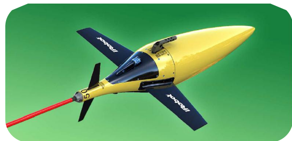
شکل ۱. سی‌گلايدر و اجزاء بیرونی آن شامل بالک‌ها، سکان و آنتن [۵].
