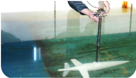
شکل ۱۴. حوضچه کشش دانشگاه دریایی امام خمینی نوشهر و نصب مدل روی ارابه
