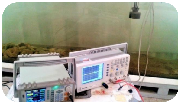
شکل ۲. ترانسدیوسرهای مستقر در آب به همراه دستگاه‌های مولد و دریافت امواج صوتی
