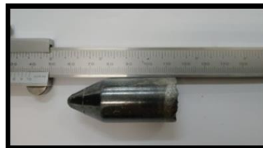
شکل ۲. تک‌بلور 0.24PIN-0.46PMN-0.3PT رشد داده شده آلاییده با منگنز.
