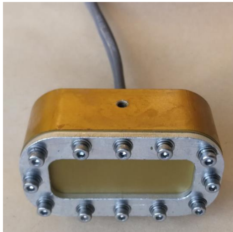
شکل ۸. مبدل ساخته شده با استفاده از المان‌های Mn:PIN-PMN-PT.
