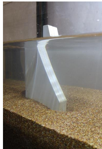
شکل ۶. تصویر توسعه آبشستگی پیرامون مدل‌های P 2 و P 4
