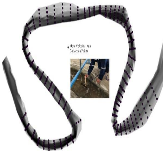
شکل ۶. موقعیت نقاط اندازه‌گیری سرعت در مسیر پیچانرودی جنگیه در رودخانه کارون
