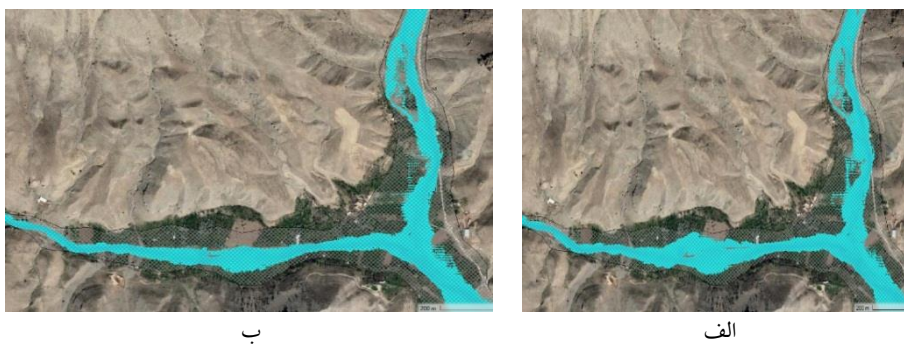
شکل ۱۷: الف. پهنه سیل قبل از احداث دیواره سیل بند در بازه ۴، ب. پهنه سیل بعد از احداث دیواره سیل بند در بازه ۴
