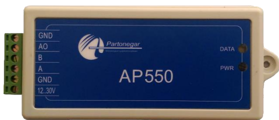
شکل ۱۱. سنسور فشار هوا.
