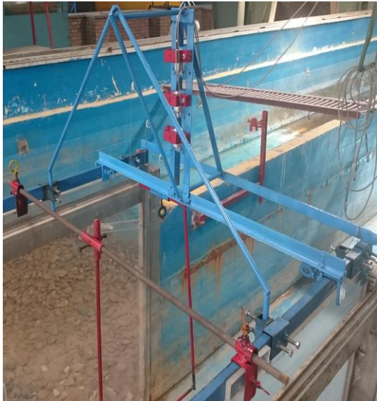
شکل ۶. پایه نگهدارنده با حسگرهای نیروسنج نصب شده
