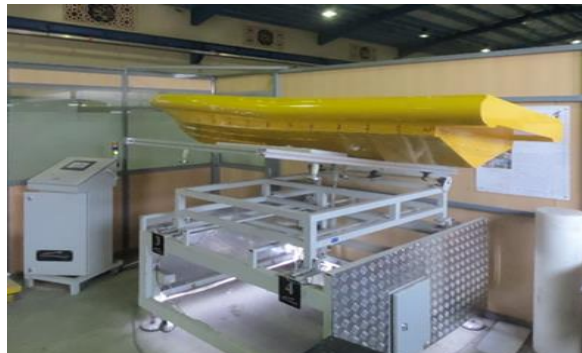
شکل ۷. تنظیم مرکز ثقل و ممان اینرسی مدل
