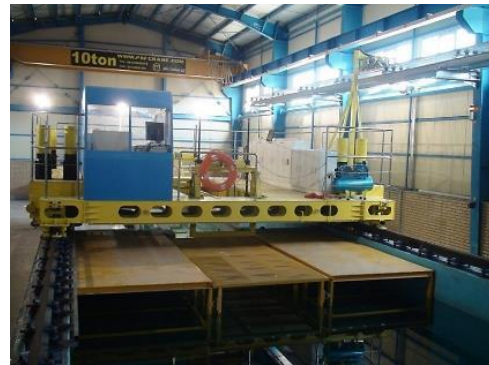
شکل ۴. نمایی از ارابه کشش حوضچه آزمایشگاه ملی دریایی خلیج فارس
