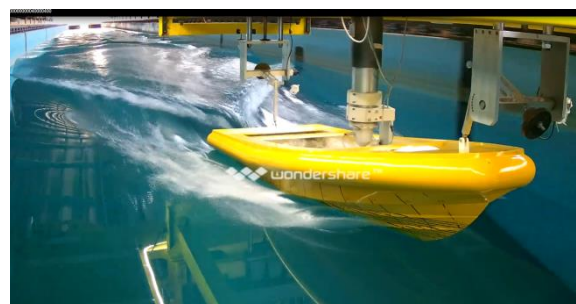
شکل ۱۰. الگوی جریان اطراف مدل شناور در سرعت 3.45 \text{ m/s} معادل F_n=0.67
