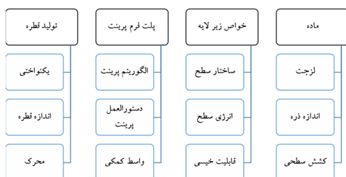
شکل ۱۱. پارامترهای اثرگذار در فرایند پرینت جوهرافشان
