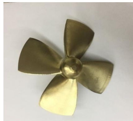
شکل ۵. مدل پروانه منطبق با پروانه اصلی
