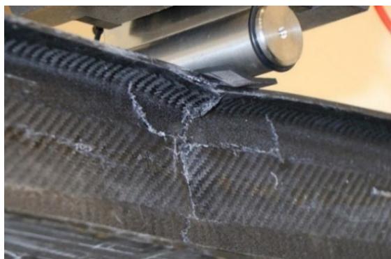
شکل ۱۷. مکانیزم شکست نهایی تیرها در آزمون‌های خمش سه‌نقطه
