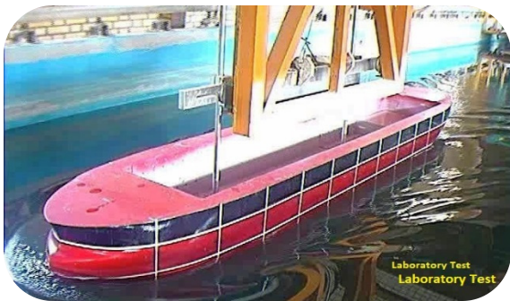
شکل ۸. مدل مقیاس شده نفت کش سالینا در حوضچه کشش دانشگاه صنعتی اصفهان
