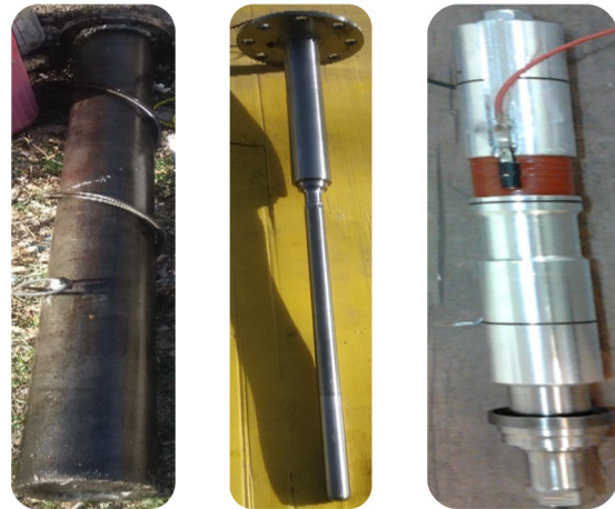
شکل ۲. الف) پیزوسرامیک‌ها و جرم بارگذاری، ب) پوسته مبدل و انعکاس‌دهنده آکوستیکی آن و ج) لوله گرم‌کننده
