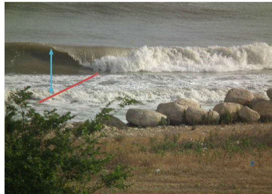
اندازه‌گیری ارتفاع موج با استفاده از رصد چشمی
