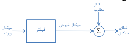
شکل ۲. ساختار کلی یک فیلتر تطبیقی
