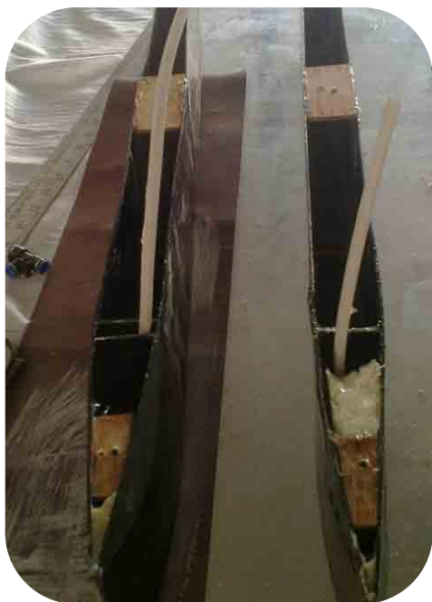
شکل ۱۰. نمایی از محفظه‌های ایجادشده برای تزریق هوا در مدل
