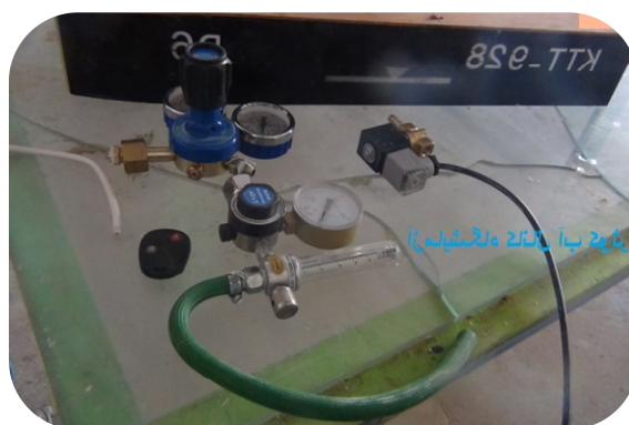
شکل ۹. تجهیزات تزریق حباب
