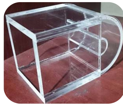
شکل ۳. بلوک طراحی شده برای ساخت مدل دیوار ساحلی
