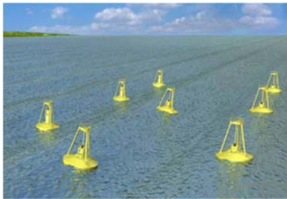
شکل ۴. دستگاه جذب نقطه‌ای انرژی موج
